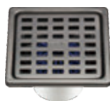
PKU536 格柵型存水防臭 尺寸：9.5x9.5cm 面蓋：1mm 管徑：2"(A)
