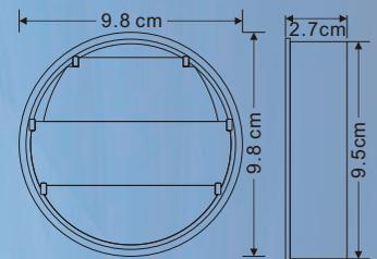
\* 口徑：適用於4" (95mm)出風口 \* 尺寸：9.8X9.8X2.7cm \* 材質：ABS塑膠 \* 產地：台灣
