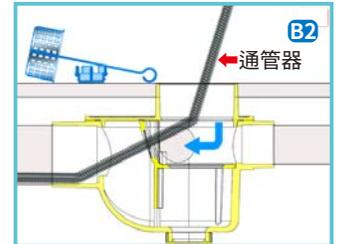
B. 內側清潔口打開，可直接使用通管器，伸入至排水管尾端作清理。
